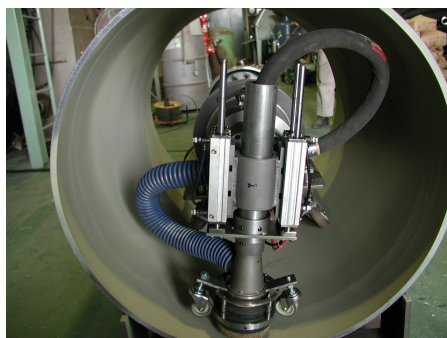
Fig.1 ブラスト除染装置の試験状況
