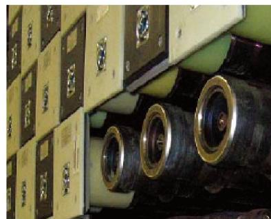
また、Pickering B NGS では、遮へい装置（正方形）として、2 片のプラスチックの間にサンドウィッチ状にはさんだ鉛合金で作られた ReactorShield（原子炉遮へい）キャップが開発された。この形状は、既に設置されている隣り合ったピース同士の間のギャップを最小化する。ReactorShield キャップは、全般的な放射線場と表面から発するストリーミング放射線の優れた、そして一貫した低減をもたらすことが実証された。この遮へいは、前回の圧力管取替作業時に使用して成功している。
